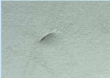
Kassettenhimmel ist im Material verformt, eingerissen oder stark verschmutzt.
