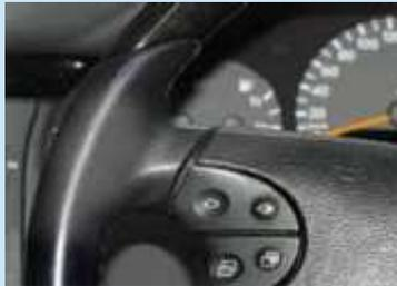
Das Lenkrad ist durch Nutzung abgegriffen. Es sind deutliche Spuren zu sehen, jedoch ist kein Material ausgebrochen.
