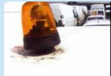
Installierte Warnlampen oder Rundumleuchten, die Glasbruch aufweisen oder nicht korrekt befestigt sind. Die Leuchten entsprechen nicht den gesetzlichen Vorschriften oder sind in der Funktion eingeschränkt.
