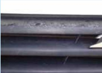
Kratzer oder Schrammen mit einer maximalen Länge von 100 mm, die bei lackierten Stoßfängern nicht durch die Lackierung gehen.
