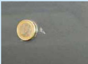
Dellen, auch mit Beschädigungen in der Lackschicht, wenn der Durchmesser 20 mm = Größe einer 1-Euro-Münze nicht überschreitet.
