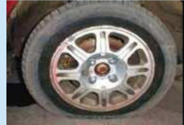
Reifen ohne dauerhaften Luftdruck – unerheblich, ob durch Beschädigung oder Eindringen von Fremdkörpern. Alle Schäden, die die Fahrsicherheit beeinträchtigen.
