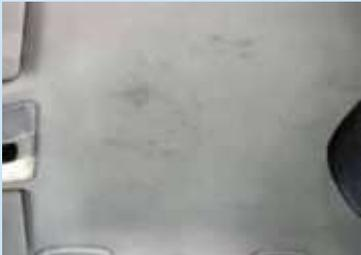
Der Fahrzeughimmel ist verschmutzt. Die Verschmutzung ist nicht nur auf der Oberfläche und durch eine herkömmliche Reinigung nicht zu beseitigen. Gespannter Himmel ist im Material oder in den Nähten aufgerissen.
