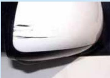
Kratzer oder Schrammen, die eine maximale Länge von 50 mm überschreiten oder bei lackierten Spiegeln durch die Lackierung bzw. bei unlackierten Spiegeln bis auf das Basismaterial gehen.
