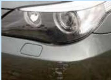
Schrammen oder Kratzer, die eine Deformierung des Stoßfängers von mehr als 20 mm (Größe einer 1-Euro-Münze) im Durchmesser zur Folge haben.
