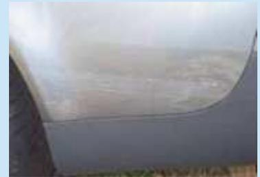
Kratzer, die länger als 100 mm oder an einem Bauteil mehrfach vorhanden sind. Außerdem alle Kratzer, die nicht durch Polieren zu entfernen sind und eine Lackierung erforderlich machen.
