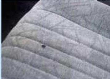
Die Polsterung ist durch Brandlöcher oder durch Schnitte beschädigt. Die Nutzung ist durch deutlich wahrnehmbare Gerüche eingeschränkt.
