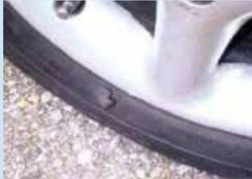
Reifen mit Beschädigungen aufgrund äußerlicher Einwirkung, wie sie üblicherweise durch Überfahren von Bordsteinen hervorgerufen werden.
