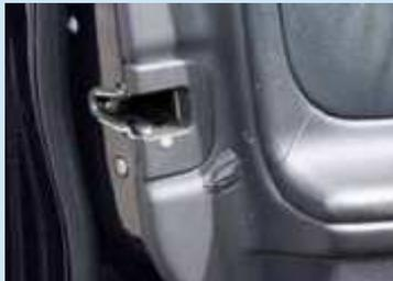
Die Innenverkleidung ist nicht durch Nutzung, sondern durch Fremdeinwirkung beschädigt. Die Türverkleidung weist durch Einklemmen des Sicherheitsgurtes Löcher, Risse oder deutliche Verformung auf.
