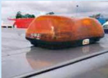
Installierte Warnlampen oder Rundumleuchten dürfen keinen Glasbruch aufweisen und die Funktion darf nicht eingeschränkt sein. Die Leuchten müssen, soweit gesetzlich vorgeschrieben, typisiert und in die Fahrzeugpapiere eingetragen sein.
