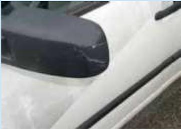
Kratzer oder Schrammen mit einer maximalen Länge von 50 mm, die bei lackierten Spiegeln nicht durch die Lackierung gehen. Bei unlackierten Spiegeln dürfen Kratzer oder Schrammen nicht bis auf das Basismaterial durchgehen. Die Funktion darf nicht eingeschränkt sein.
