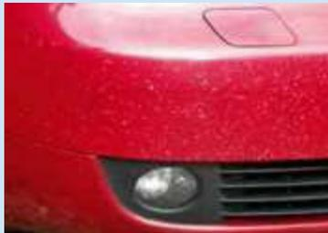
Steinschläge, die mehr als ein Viertel eines Bauteils bedecken oder wenn sie durch die Lackschicht bis auf das Grundmaterial gehen.
