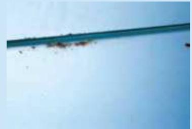
Dellen, Beulen oder Kratzer mit Lackbeschädigungen, die bis zum Grundmaterial reichen und/oder Rostansatz aufweisen.
