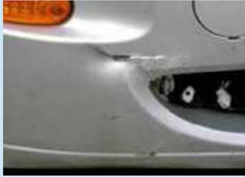
Stoßfänger mit Rissbildungen oder Einschnitten durch Fremdeinwirkung. Fehlende Abdeckungen von Abschleppösen oder abnehmbaren Anhängerkupplungen.
